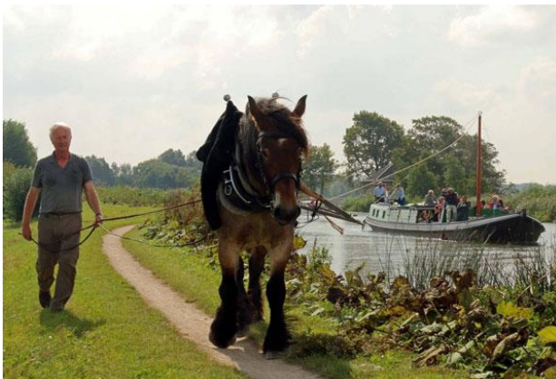
Afb. 12 Een trekschuit, voortgetrokken door een paard dat op het jaagpad loopt.
